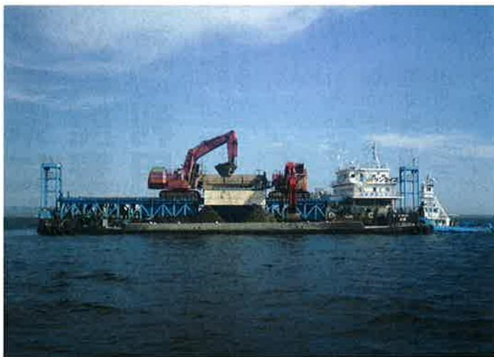
写真4 二重トレミー管により海底部に土砂を投入
