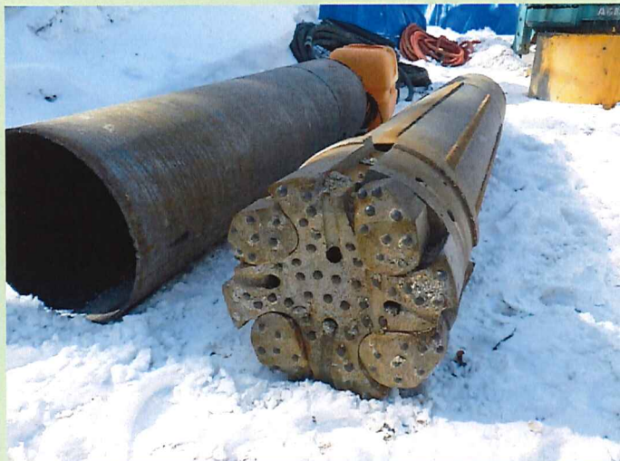
ダウンザホールハンマー
