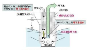
重力に加え負圧(真空ボンブ)により地下水を集め、 水中ボンブで揚水する地下水位低下工法 図4:「SWP工法」の原理
